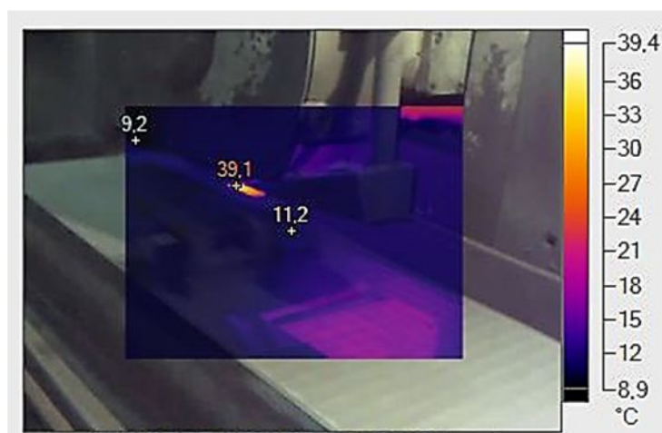
Рис. 7. Распределение температурных полей при шлифовании металлополимерного образца
