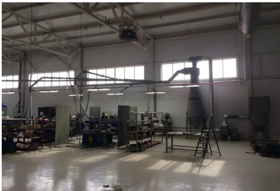
Рис. 1. Система аспирации заточного участка ООО Производственная Фирма "Русский инструмент"
